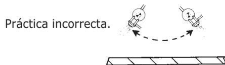
a) Si se mueve el dispositivo de proyección en forma de arco se obtiene un Material de Calidad deficiente y se aplica una Proyección Excesiva.
